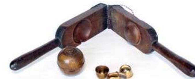
Ручна преса за трохисце и прибор за израду пилула A manual press for trochiscs and accessories for making pills
