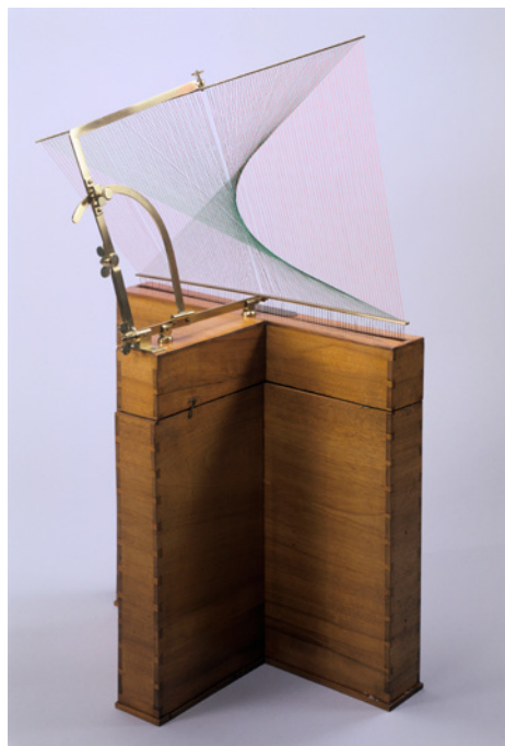
Paraboloïde hyperbolique, génération rectiligne double. Modèle pour l'enseignement de la géométrie descriptive construit par la maison Pixii Père et Fils pour le professeur Théodore Olivier, 1830 Inv. 4439 © Musée des arts et métiers-Cnam/ S. Pelly
