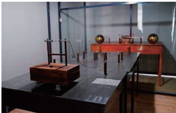
图 7 电子科技大学博物馆复原的赫兹实验。拍摄：王念慈
